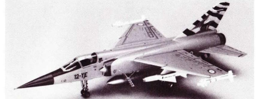
ダッソー・ブレゲー、ミラージュF.1Cは、フランス空軍の全天候型迎撃戦闘機です。主翼はミラージュの特徴であるデルタ翼から通常の高翼配置に改められ、離着陸性能の向上がはかられています。火器管制装置もより強力なシラノ4型を搭載し、高空迎撃だけでなく対地攻撃にもその威力を発揮します。ミラージュF.1シリーズには、C型の他にA,B,R,E,の各型があります。《データ》乗員1名、全幅8.40m、全長15.00m、全高4.50m、最大離陸重量14,900kg、エンジンSNECMA アター9K50×1、推力5,000kg (A/B使用時7,200kg)、最大速度マッハ2.2/12,200m、固定武装：30mmDEFA砲×2、原型初飛行1966.12.23、初飛行1973.2.15。
