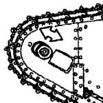
★キャップスクリューをゆるめ、四の部分を動かして履帯の張りが調整できます。
