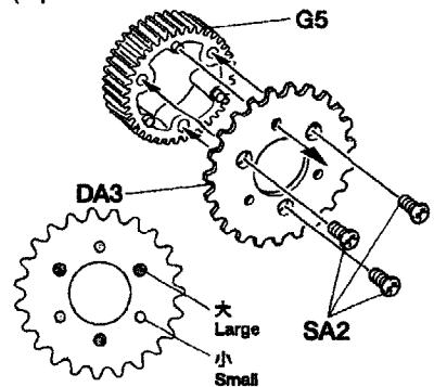
② ①で組み立てたものに、DA3と同じ方法で取り付けます。
