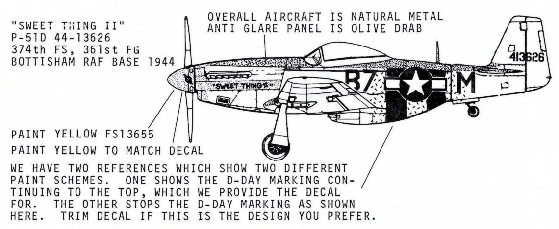
OVERALL AIRCRAFT IS NATURAL METAL ANTI GLARE PANEL IS OLIVE DRAB FICKLE FANNY BLUE DECAL
