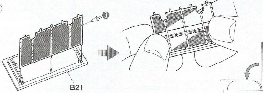
★エッチングパート③を切り出し、B21のジグの図の部分に向こうに注意してエッティングの爪をはめます。次に図のように指で曲げ、形を整えます。
