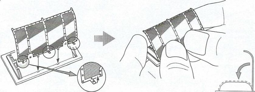
★エッティングパート③の反対側も同様に曲げていきます。その際、○で示した3カ所の部分は90度曲げておきます。
