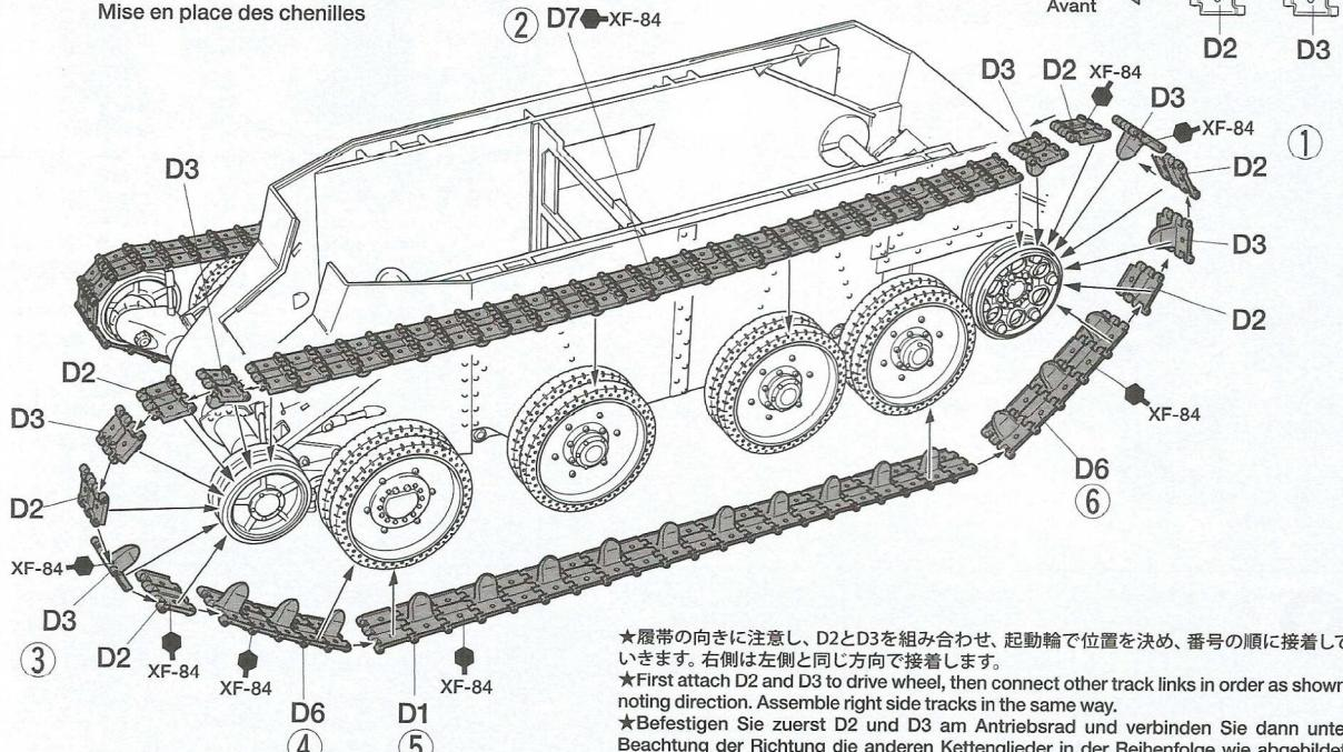
★履帯の向きに注意し、D2とD3を組み合わせ、起動輪で位置を決め、番号の順に接着していきます。右側は左側と同じ方向で接着します。
