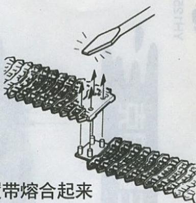
用热起子将履带熔合起来
